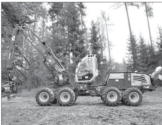
Svahový harvestor HSM 405 H3 8wd Steilhang
